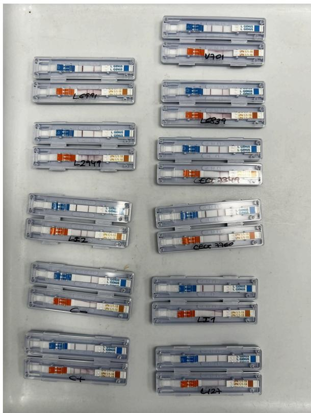
Imagen 2: ensayos realizados mediante la prueba inmunocromatográfica “M-Ident® Virapid® Legionella”
